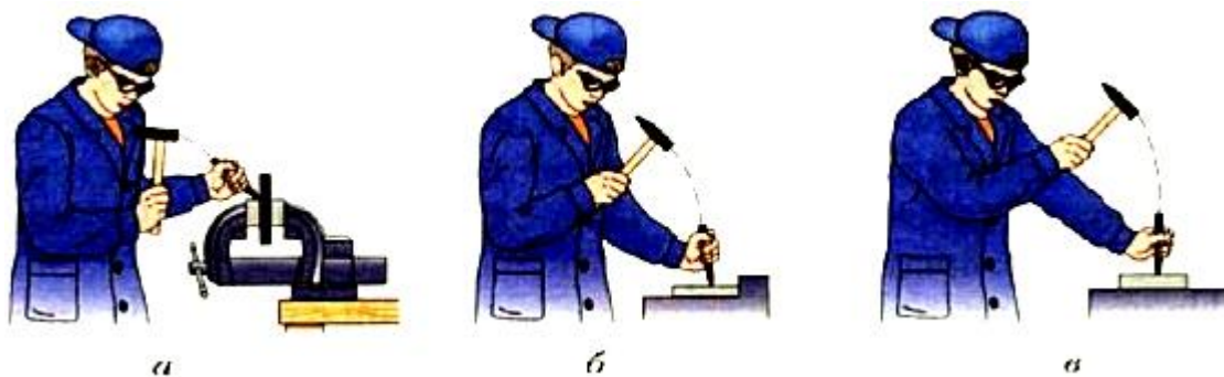
Рис. 73. Приёмы рубки металла в тисках: а — кистевой удар; б — локтевой удар; в — плечевой удар
