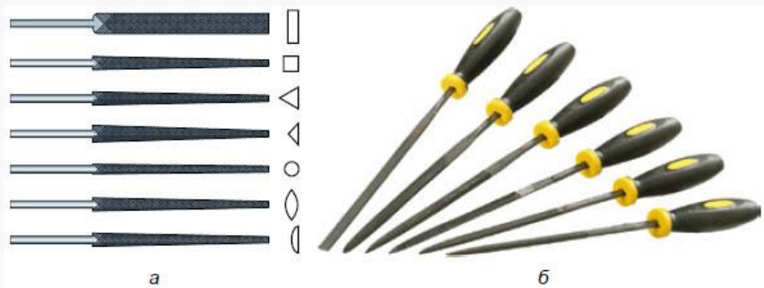
Рис. 7. Виды надфилей: а – схематическое изображение; б – общий вид
